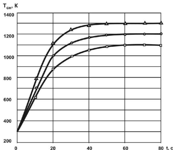
Рис. 2. Тепловые характеристики свечи накаливания SN11-0,1 01 при различных напряжениях питания ( $U_{сн}$ ) её нагревательного элемента:
