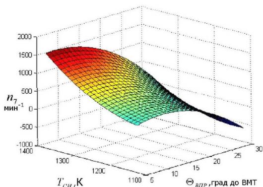
Рис. 5. Характер воздействия  $T_{сн}$  и  $\Theta_{впр}$  на разгон КВ в процессе попытки пуска ВМД при исходной  $n = 350 \text{ мин}^{-1}$
