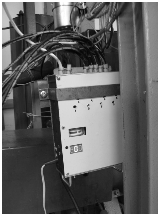
Рис. 2. Блок-усилитель ИСМП в составе моторного стенда
