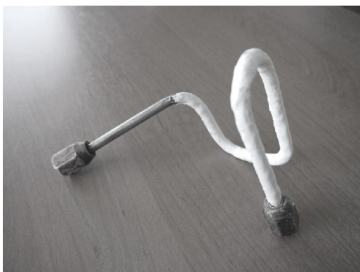
Рис. 3. Топливопровод, покрытый теплоизоляцией «Астратек металл»
