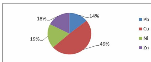
Рис. 5. Концентрации металлов в ТЧ на режиме №5 при Ne=75%, n=1750 мин<sup>-1</sup>
