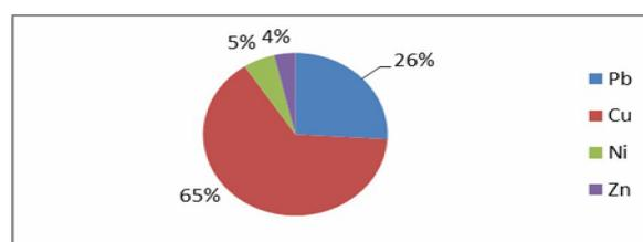
Рис. 6. Концентрации металлов в ТЧ на режиме №12 при Ne=75%, n=1500 мин<sup>-1</sup>
