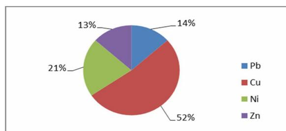
Рис. 4. Концентрации металлов в ТЧ на режиме №1 при Ne=50%, n=1250 мин<sup>-1</sup>
