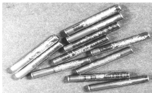
Рис. 4. Игольчатые ролики с началом разрушения
