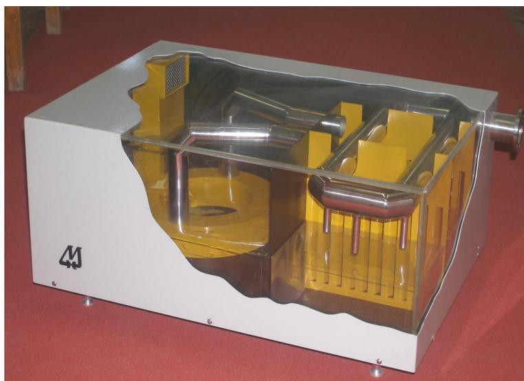
Рис. 2. Выставочный макетный образец дизельного жидкостного нейтрализатора
