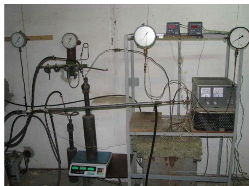
Рис. 1. Експериментальний стенд для отримання синтез-газу
