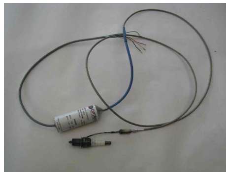
Рис. 5. Свічка запалювання з датчиком тиску OPTRAND
