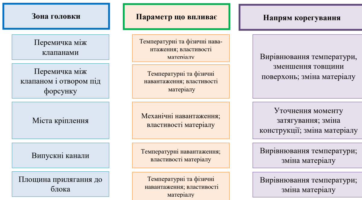
Рис. 3. Схема шляхів забезпечення надійності головки циліндра
