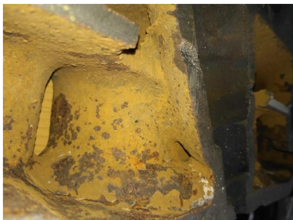
Рис. 4. Приклад стану внутрішньої поверхні головки циліндрів [12]
