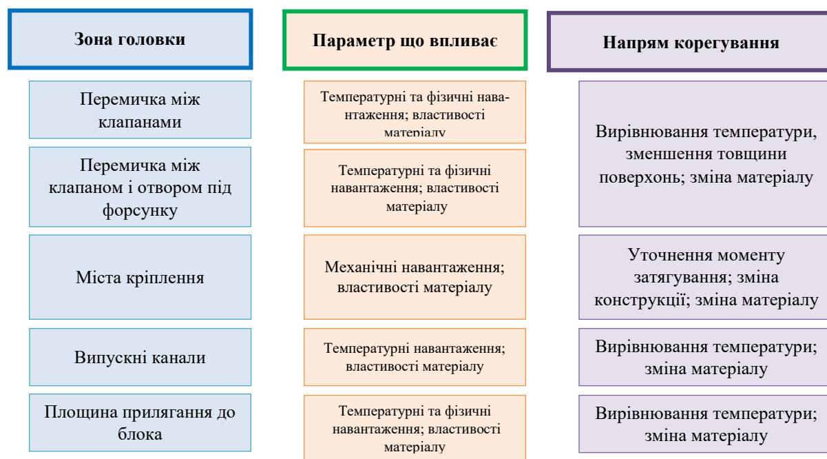
Рис. 3. Схема шляхів забезпечення надійності головки циліндра
