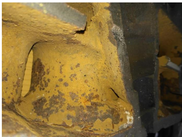
Рис. 4. Приклад стану внутрішньої поверхні головки циліндрів [12]
