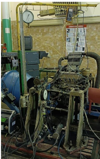
Рис. 2. Експериментальна установка на базі двигуна МемЗ-307
