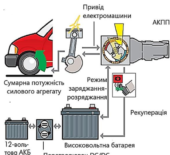
Рис. 3. Схема середньогібридного силового агрегату [3]
