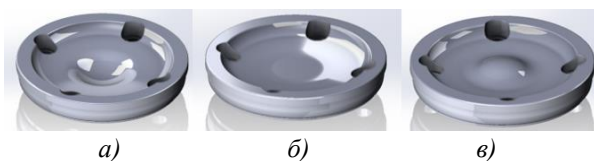
Рис. 5. Варіанти камер згоряння: а) вихідна; б) плоска; в) з витиснювачем
