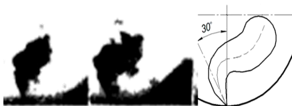
Рис. 5. Зіставлення моделювання розвитку паливних струменів із результатами розрахункового експерименту
