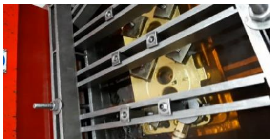
Рис. 9. Процес опресування головки блоку циліндрів двигуна 4ЧН 8,8/8,2 на обладнанні Piccinotti
