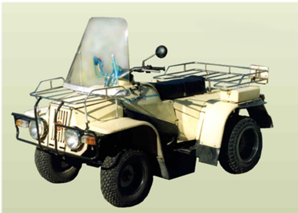
Рис. 1. Серійний зразок чотириколісного мотоциклу ЗІМ-800Д з дизелем 2ДТМ (фото 1998 р.)
