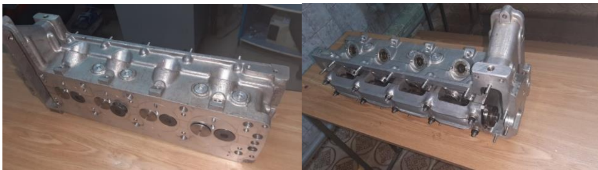
Рис. 11. Фотографії головки блоку циліндрів двигуна 4ЧН 8,8/8,2 у зборі
