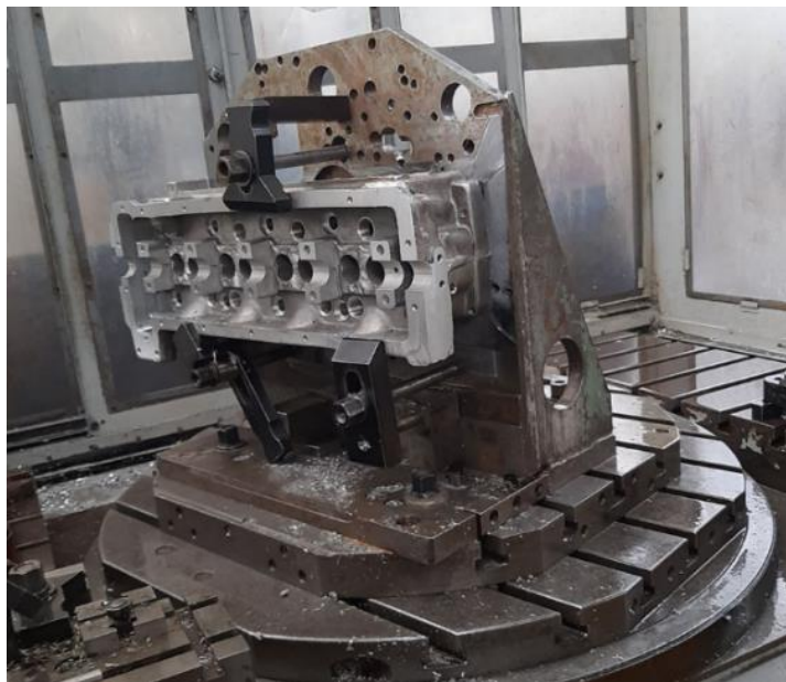
Рис. 7. Процес механічної обробки головки блоку циліндрів дизеля 4ЧН 8,8/8,2
