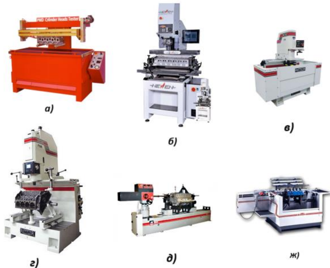
Рис. 8. Спеціалізоване обладнання для механічної обробки деталей двигунів внутрішнього згоряння:
