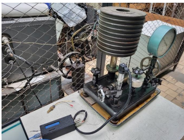
Рис. 5. Лабораторна установка тарування датчику тиску (а) та зовнішній вигляд датчика тиску ПД100-111/171/181 (б)
