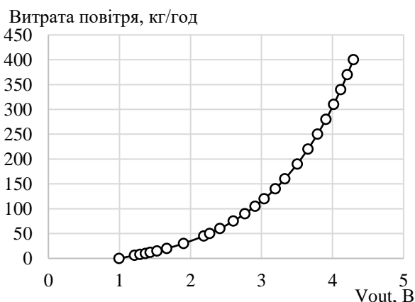
Рис.8. Залежність масової витрати повітря через MAF-датчик BOSCH 0280218 037 від вихідної напруги
