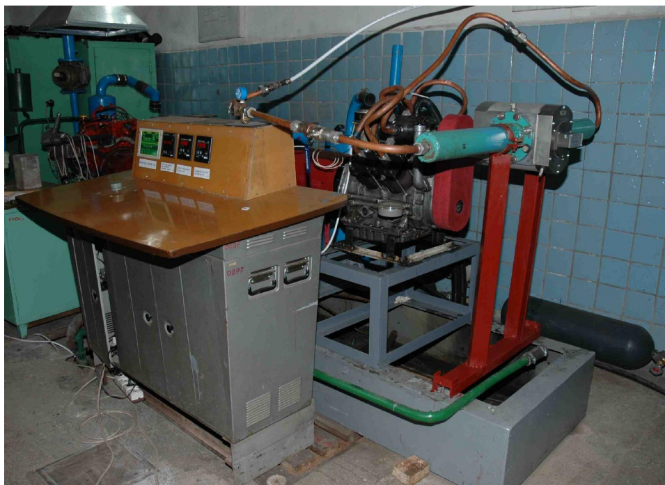
Рис. 2. Загальний вигляд стенда для дослідження пневмодвигунів
