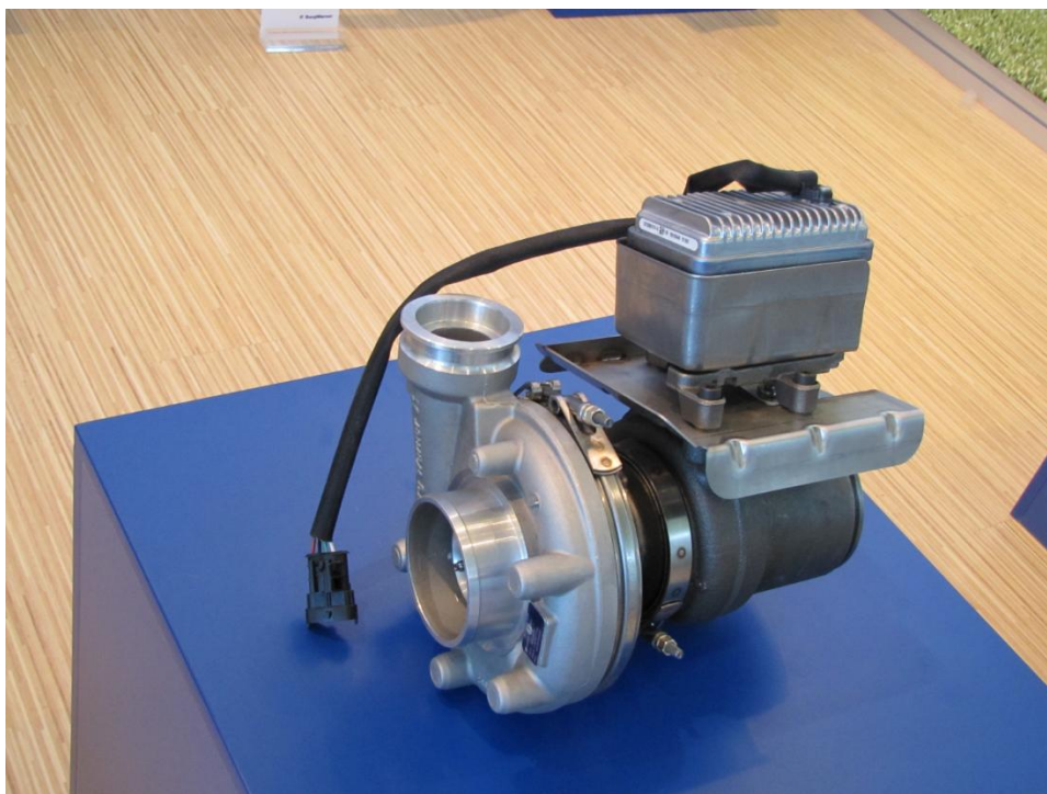
Рис. 5. Електропривідний компресор розробки фірми BorgWarner
