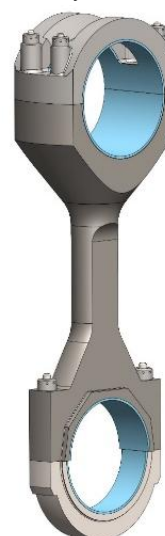
Рис. 4. Твердотільна модель шатуна в зборі дизеля K90MC-C
