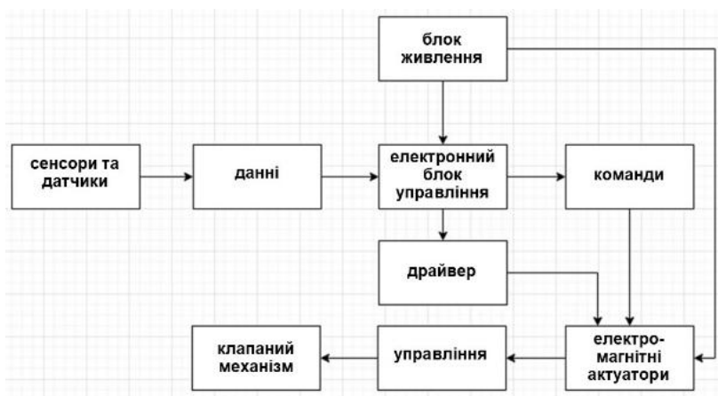
Рис. 6. Принципова схема керування клапанами газообміну з використанням актуаторів
