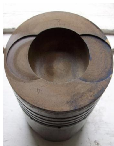
Рис. 2. Поршень з каталітичним покриттям на основі оксиду кобальту
