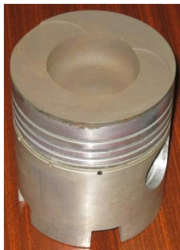
Рис. 1. Поршень з каталітичним покриттям на основі оксиду марганцю
