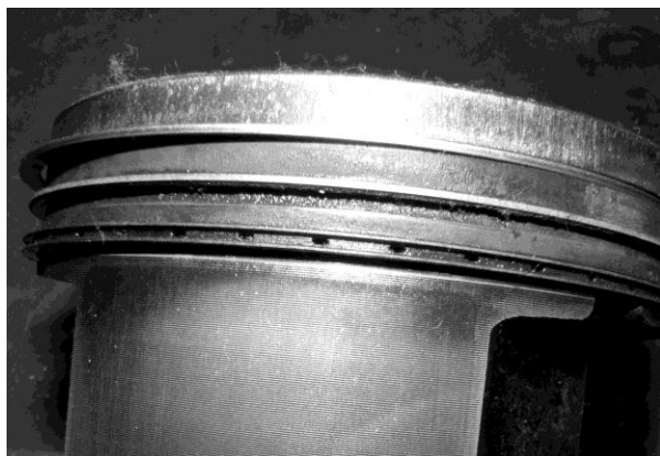
Рис.7. Повреждение огневого пояса поршня при отсутствии заметных повреждений юбки
