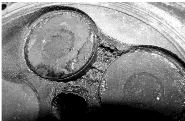
Рис.4. Камера сгорания со следами плавления стенки между седлами выпускных клапанов – номинальный режим работы ДВС (в движении)
