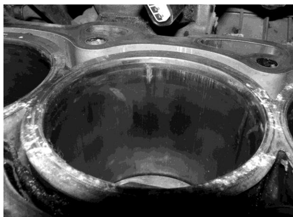
Рис.6. Задир в верхней части цилиндра от перегрева при потере ОЖ (хорошо видны следы прорыва газов на плоскости). Нижняя часть цилиндра повреждений не получила
