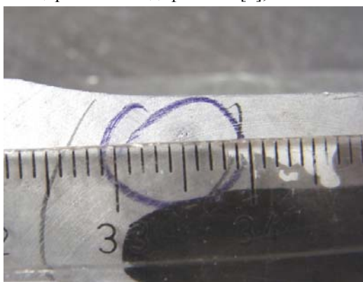
Рис. 1. Результат макроанализа поршня с дефектами усадочного характера в днище поршня (данные ОАО «АВТРАМАТ»)
