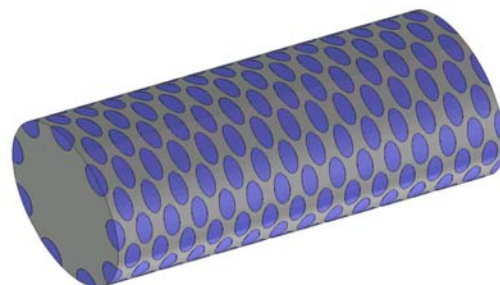
Рис. 2. Фрагмент упрочненной части опорной поверхности вала (геометрия показана условно)
