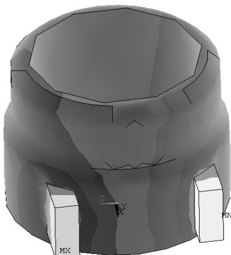
Рис. 3. Распределение относительных потерь в зарубашечном пространстве двигателя
