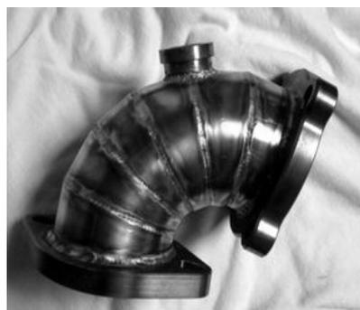
Рис. 3. Колено газораспределительного коллектора
