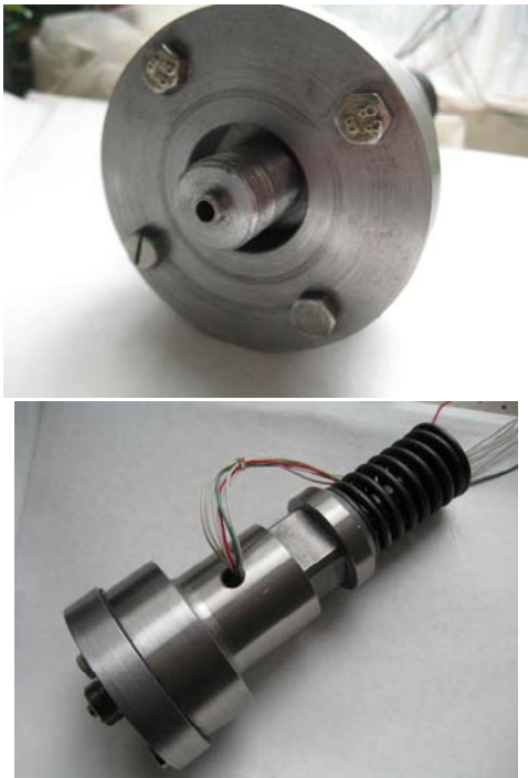
Рис. 1. Загальний вигляд складеного корпусу з встановленим клапаном
