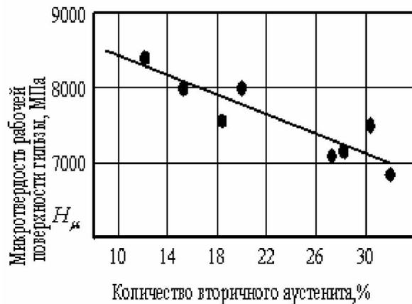
Рис. 2. Зависимость микротвердости поверхностного слоя ГЦ дизеля 8Ч 13/14 от количества образовавшегося вторичного аустенита после 60 часов ускоренных испытаний
