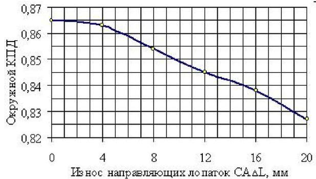
Рис. 4. Зависимость КПД на окружности при эрозии СА турбины
