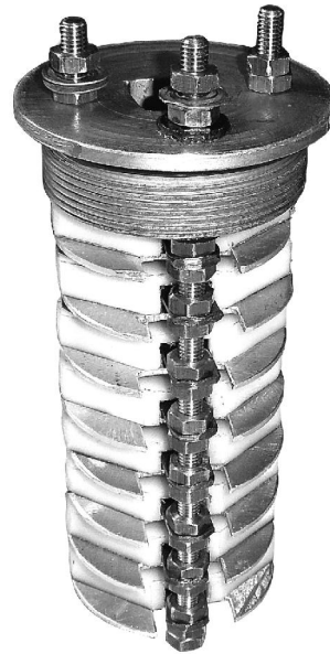
Рис. 1. Підігрівач масла в маслобаці енергоагрегата ЕА-10М з керамічними нагрівачами
