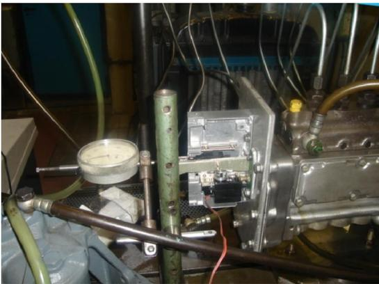
Рис. 3. Экспериментальный образец исполнительного механизма МР на ТНВД
