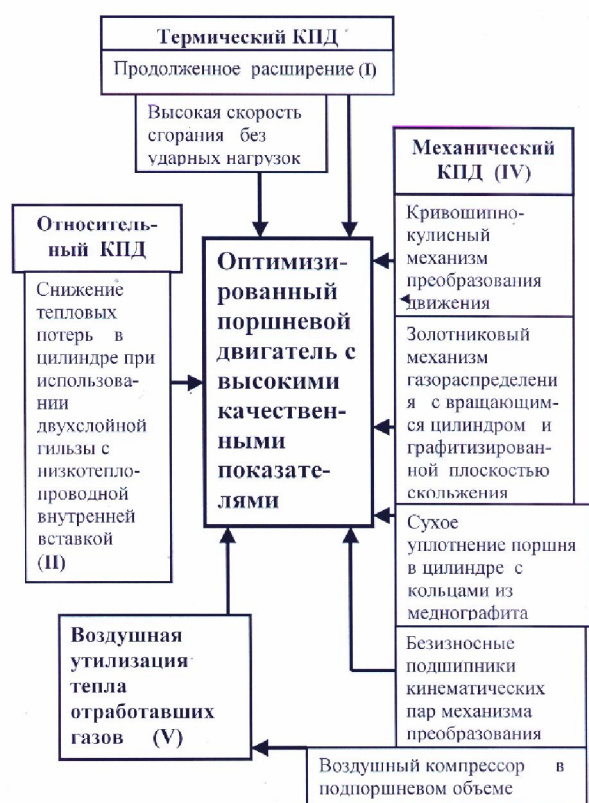
Рис.2. Блок-схема совершенствования двигателя при влиянии на все составляющие эффективного КПД и с утилизацией.
